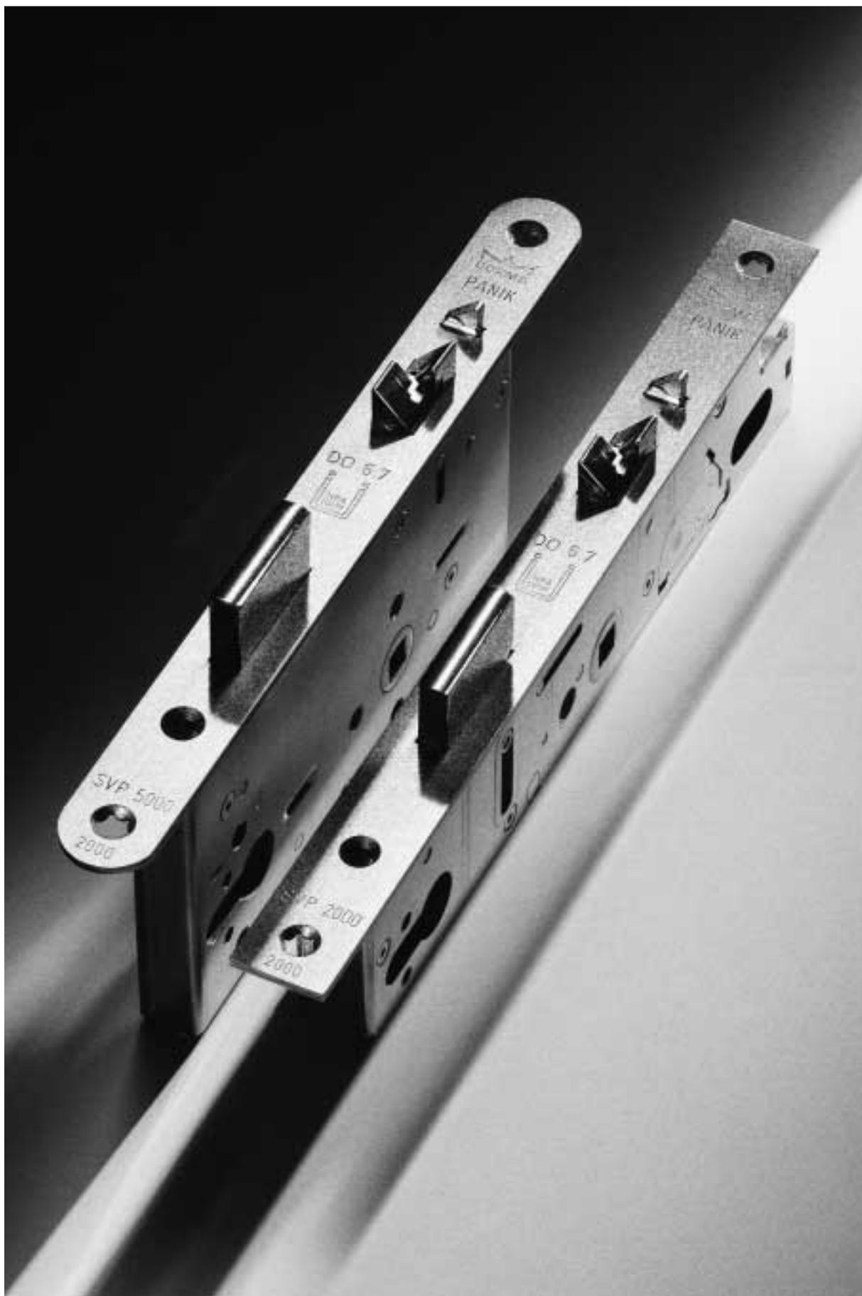
Selbsttätiges Verriegeln von Türen sofort nach jedem Schließen, indem sich der Riegel automatisch vorschleibt – das ist der entscheidende Vorteil, den die selbstverriegelnden Antipanik-Schlösser DORMA SVP bieten. Gleichzeitig arretiert die Kreuzfalle, so dass eine „Zweipunktverriegelung“ entsteht.
